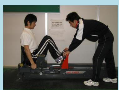
スピード条件（速い～遅い）を変えて、脚全体（多関節）のパワーを測定する。
