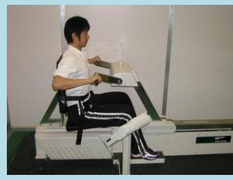
スピード条件（速い～遅い）を変えて、上肢（多関節）のパワーを測定する。
