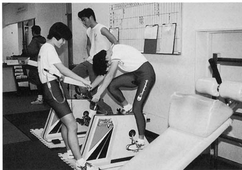
写真1 最大無酸素パワー測定・トレーニング用自転車エルゴメータ
